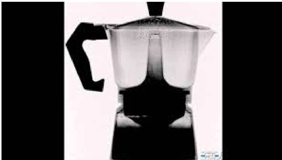
Figur 9.17: For nøytroner er aluminium gjennomsiktig og vann ugjenomtrentelig! Her er bilde av en mokka-trakter i aluminium, fylt med vann nederst. Bildet er starten på en film som viser hvordan vannet beveger seg opp til den øvre beholderen når det kokes opp. Filmen er laget av A. Kaestner ved PSI (Paul Scherrer Institut), Sveits (se https://www.youtube.com/watch?v=VESMU7JfVHU )
